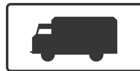
b) T-23b tabliczka wskazująca samochody ciężarowe, pojazdy specjalne, pojazdy używane do celów specjalnych, o dopuszczalnej masie całkowitej przekraczającej 3,5 t oraz ciągniki samochodowe
